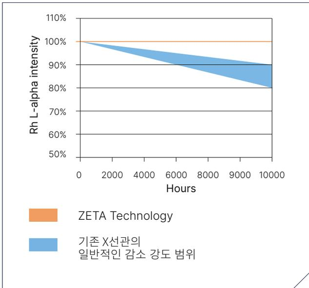
Revontium을 사용하면 신중하게 설계된 고품질 하드웨어 및 소프트웨어 구성 요소 덕분에 XRF 스펙트럼의 모든 신호를 처리할 수 있습니다. 특허를 받은 Revontium의 밀접 결합 X선관은 이 기기를 위해 특별히 설계되었으며, 무중발 기술 발전(ZETA)을 통해 드리프트가 매우 낮습니다. 누출을 방지하는 기능과 함께 장기적인 안정성을 제공합니다.
