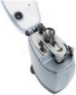
汎用トレイ (Aero S用) ホッパー付き。連続的で安定的なサンプル供給ができます。
