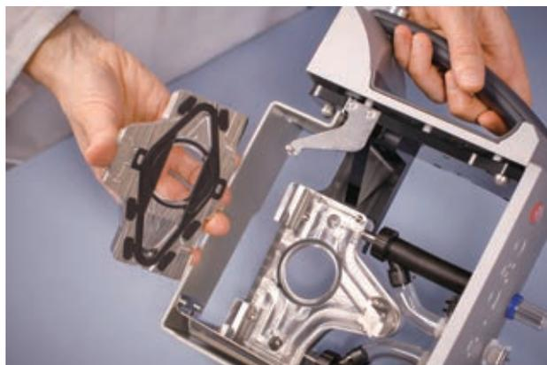
①セルロックレバーを回転させます。②ワンタッチでセルウインドウが外れます。
