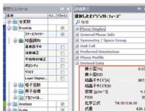
酸化チタンのリートベルト解析と結晶子径/歪
