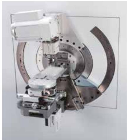
ウェルプレートを用いた透過測定
