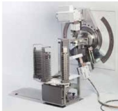
45試料サンプルチェンジャーを用いた反射・透過測定
